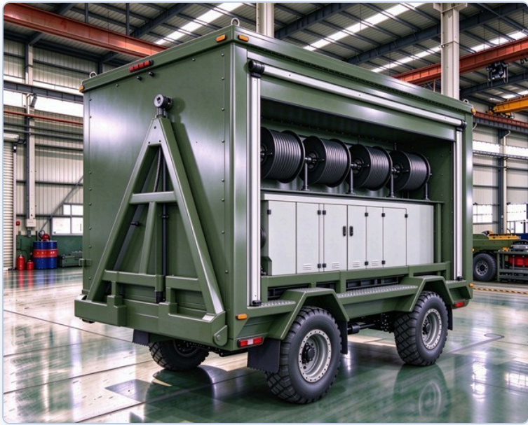
样车实拍·侧后视角 | 两轴四轮拖挂底盘、A 型牵引架与卷帘舱门一览
