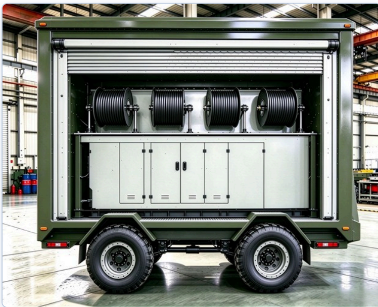
样车实拍·正面视角 | 卷帘侧门全开：上层八组线缆卷轴，下层集成式配电控制柜
